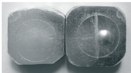
Рис. 2. Тыльная сторона алюминиевых образцов с крупнозернистой (слева) и ультрамелкозернистой (справа) структурами после облучения на ускорителе «Синус-7»
