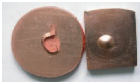
Рис. 1. Тыльная сторона медных образцов с крупнозернистой (слева) и ультрамелкозернистой (справа) структурами после облучения на ускорителе «Синус-7»
